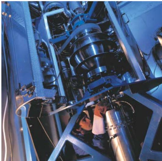
Image du dispositif « Derviche Tourneur Sodium ». La sphère externe en acier inox (au centre de l'image) renferme une sphère interne (ou graine) en cuivre, plus petite. Entre les deux se trouvent 40 litres de sodium liquide. Le rapport des rayons des deux sphères est identique à celui entre la graine et la limite noyau-manteau de la Terre. Le sodium représente donc par analogie le noyau fluide.
