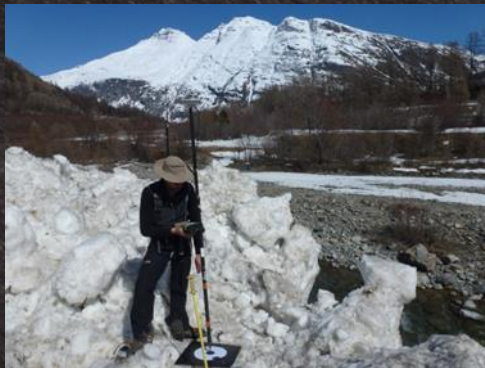
Mesure de cibles avec le Leica zeno 20, précision centimétrique, Emmanuel Thibert
