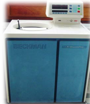
Ultra-Centrifugeuse (séparation de particules)
