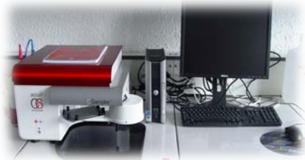
Cytomètre de flux automatisé (Comptage de particules bio-nano-organiques-minérales)
