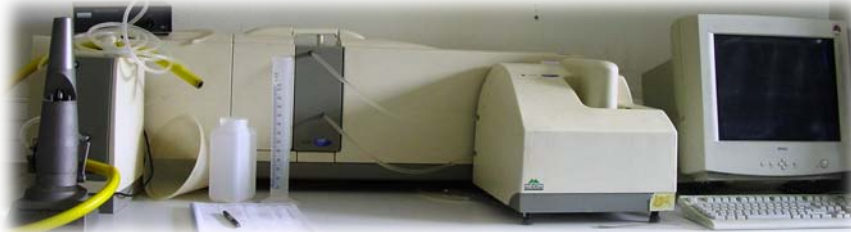
Granulomètre laser (taille des particules)
