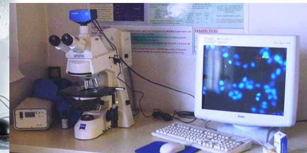
Microscope à épifluorescence (Enumération cellulaire)
