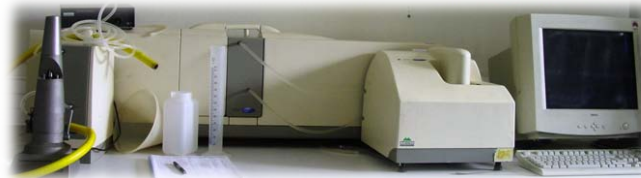
Granulomètre laser (taille des particules)
