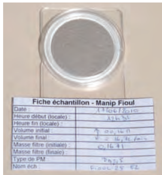
Prélèvement en sortie de chaudière au Fioul © Jean-Luc Besombes/Université de Savoie
