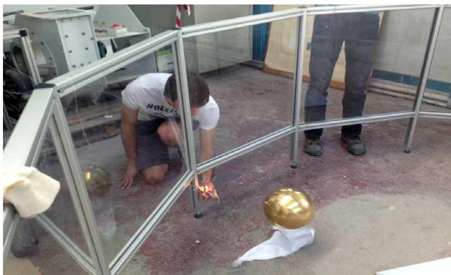
Lancement du pendule de Foucault par étudiant pendant son stage L3 par brûlure de ficelle.
