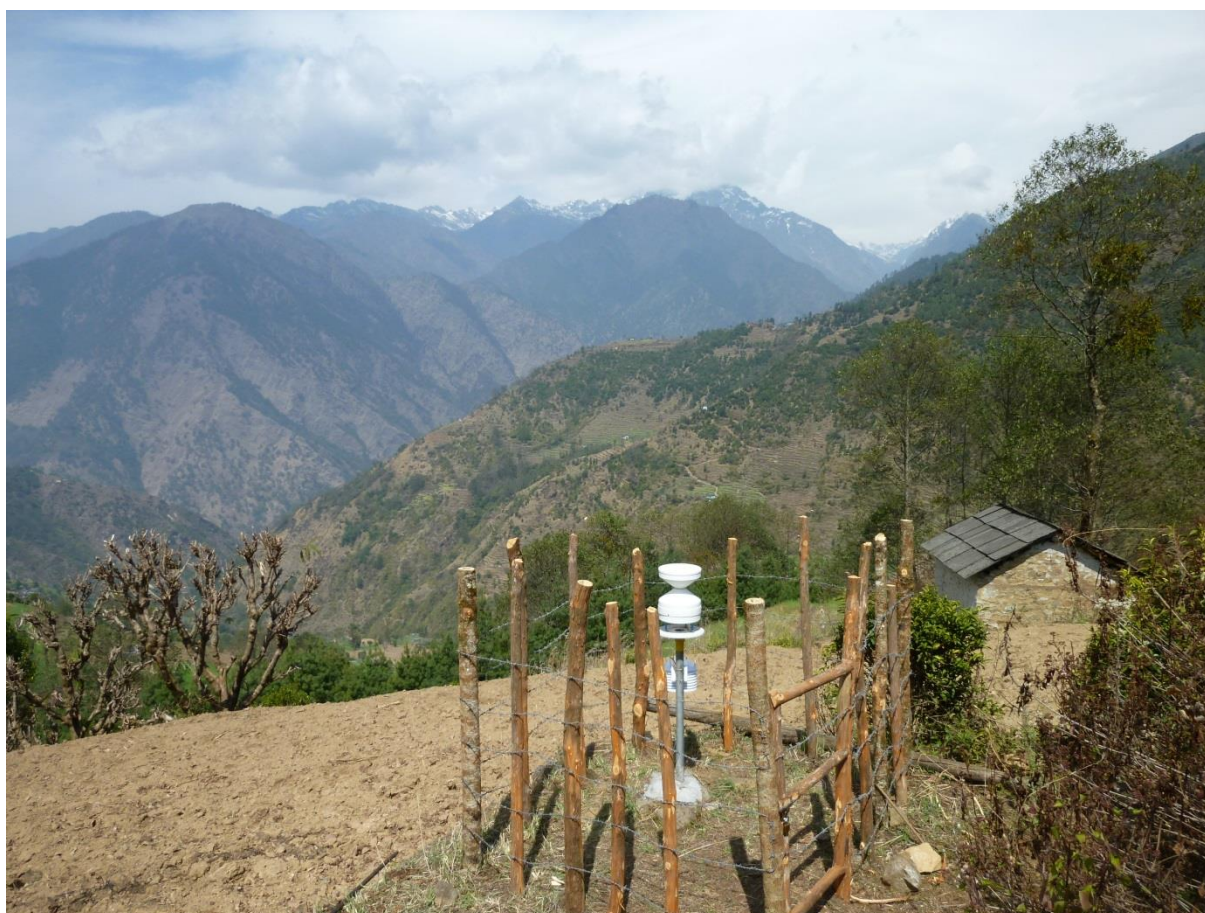
Pluviomètre installé à Kharikhola (Népal). (crédit : L.Mimeau)
