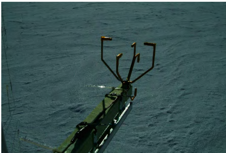
Figure 1: Le thermoanémomètre rénové chez ApTec sur financement LabEx, en place sur la tour de Dôme C fin Janvier 2013.
