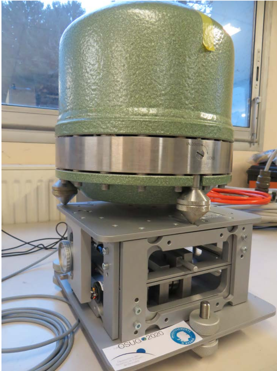
Figure 2 : Calibration d'un sismomètre large bande (120s-50Hz) Streickheisen STS-2
