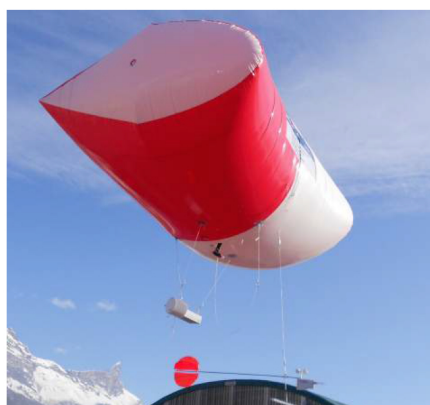
Figure 1 : (a) Ballon captif portant les sondes de température, pression et humidité de type Vaisala et Campbell (photo Julie Allard). (b) Comparaison des profils nocturnes de température enregistrés par les deux sondes durant une montée et une descente successives du ballon (extrait du rapport de M2-R de Isabel Peinke).
