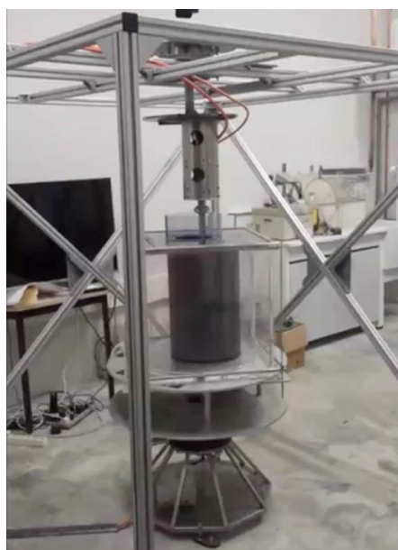
Figure 2. L'expérience EDEN : un montage de Taylor-Couette excentrique. (Gauche) Montage expérimental final. (Droite) Une simulation avec Nek5000 de EDEN (les rouleaux de Taylor près du cylindre interne sont dus à une instabilité de l'écoulement de base 2D).
