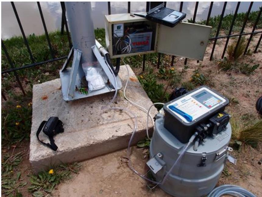
Figure 3 : échantillonneur ISCO sur la rivière Katari
