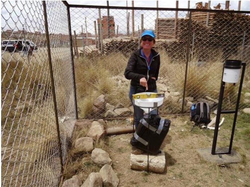
Figure 2 : jauge Owen et pluviomètre sur le site de Brabol dans la ville d'El Alto
