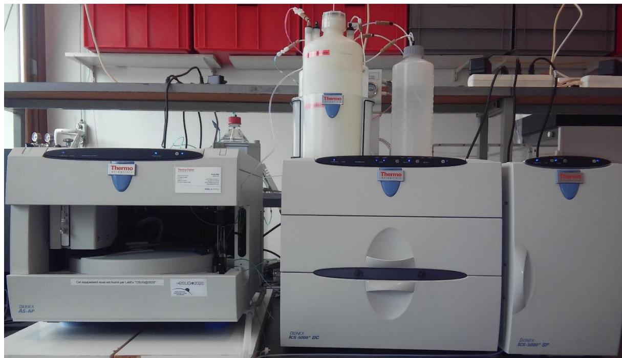
HPLC-PAD : à gauche le passeur automatique AS-AP et à droite l'HPLC-PAD
