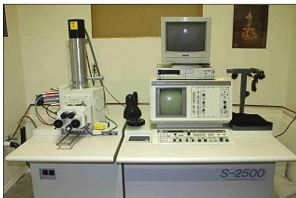
Microscope électronique à balayage
