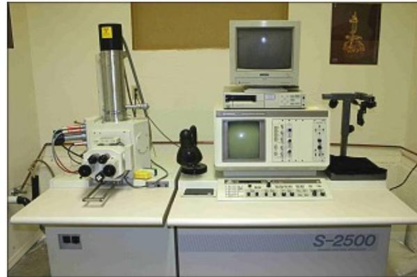
Microscope électronique à balayage
