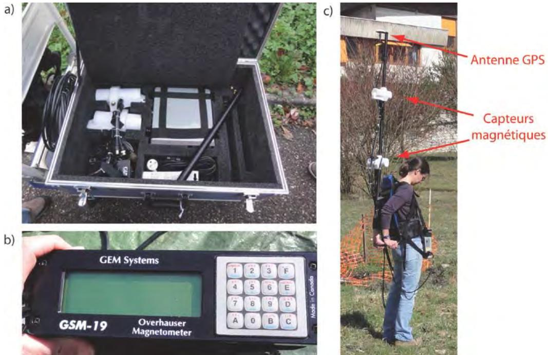
Figure 1: Magnétomètre-gradimètre GSM-19WG de GEM System : (a) valise de rangement, (b) console d'acquisition, (c) Instrument assemblé.
