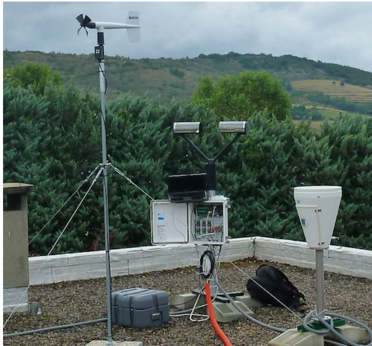
Figure 1: Anémomètre installé proche d'un pluviomètre et disdromètre du réseau HPicoNet au collège Laboissière à Villeneuve de Berg.
