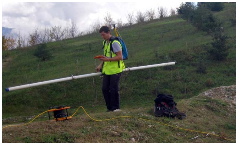
Figure 1 : acquisition EM31 sur le site de stockage de déchets de Chatuzange (Drôme) en novembre 2014. Source : G. Bièvre.
