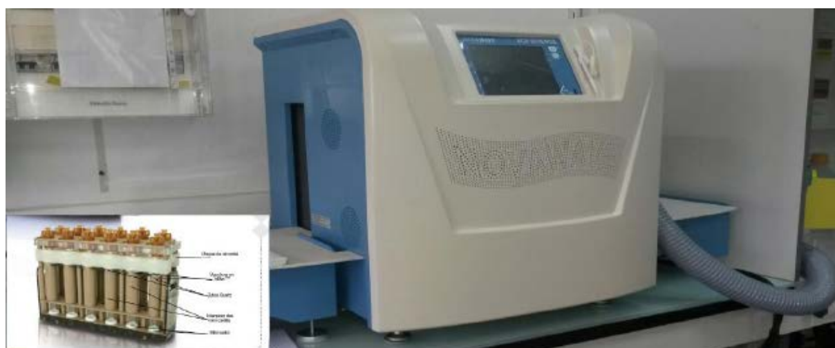
Figure 3 - Digesteur Micro-onde SCP science 'NOVAWAVE' installé au LTHE. Insert : rack de cellules extractives avec contrôle individuel de la température. Crédit : Marie-Christine Morel.
