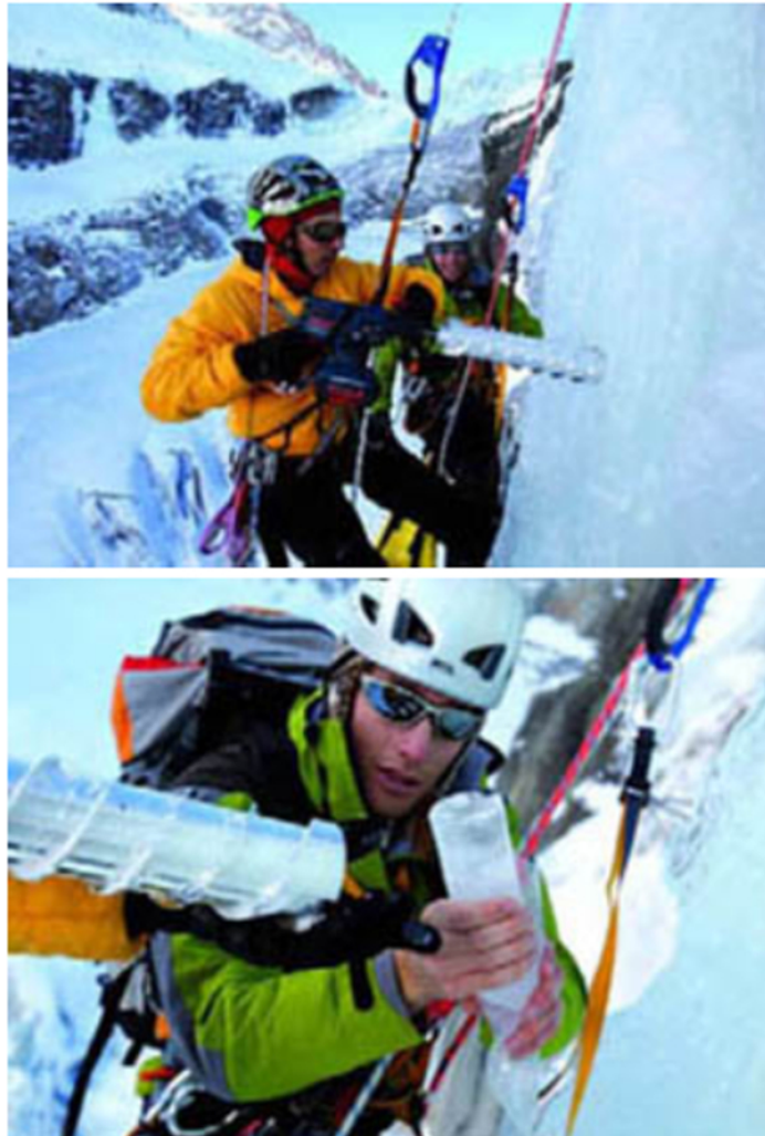
Le guide de haute montagne François Damilano (au premier plan) et Pierre-Alexandre Labory, étudiant au laboratoire, effectuent un prélèvement à l'aide d'un carottier portatif conçu et fabriqué au LGGE. © M. Dalmaso
