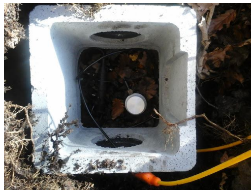
capteur sismologique de la flute Galerie et alimentation (glissement de Séchilienne)
