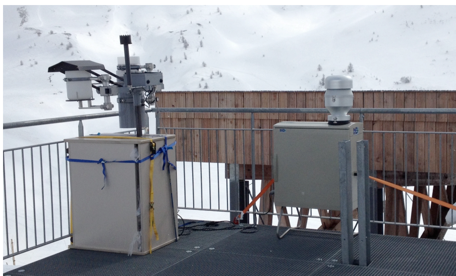
Illustration 1 : Appareils de collecte installés sur le toit terrasse de la Galerie de l'Alpe, mars 2016. A gauche, le collecteur de dépôts humides, à droite le collecteur d'aérosols.
