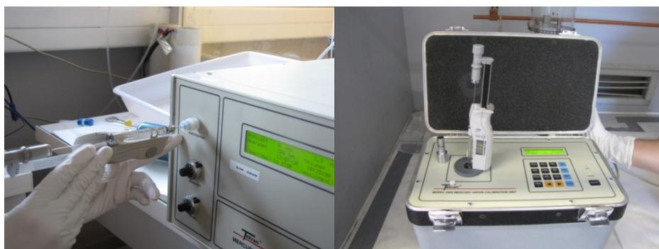
Figure 1 : photo de droite : source de calibration pour injection de mercure. A gauche, injection test en laboratoire dans l'instrument Tekran 2537. Crédit : ADommergue
