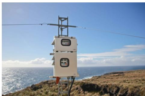
Figure 2 : Photo de l'instrumentation de mesure de mercure atmosphérique sur l'Île d'Amsterdam. Crédit : Manuel Barret.
