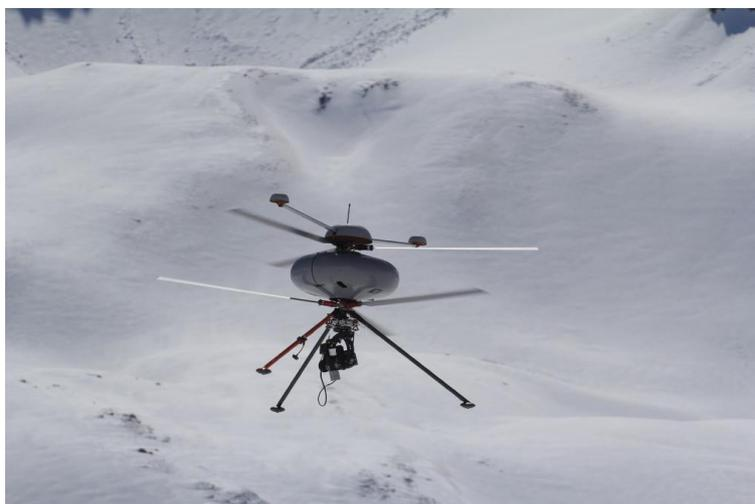
légende 2 : Les 2 antennes du GPS différentiel sur le dessus du drone : partie visible du module de navigation permettant d'obtenir le cap sans référence magnétique, financé par le labex [OUSG@2020](#). Crédit photo B. Jourdain
