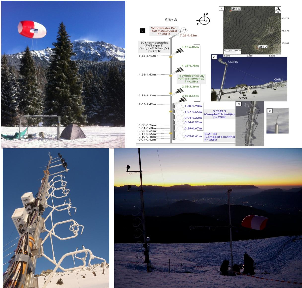
Figure : Localisation des sites de mesures de la campagne d'étude du vent catabatique sur forte pente dans le massif de Belledonne 2019. Mat instrumenté en sondes 3D de turbulence. Ballon captif instrumenté en sondes météo.
